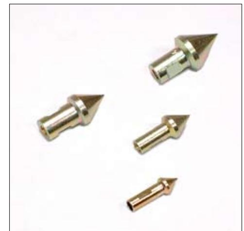
Wird der Konus in den Boden eingetrieben, registriert der Penetrologger über einen internen Ultraschallsensor mit hoher Präzision die Tiefe bis zu 80 cm, wobei die Tiefenbezugsplatte (5) zum Einsatz gelangt.
