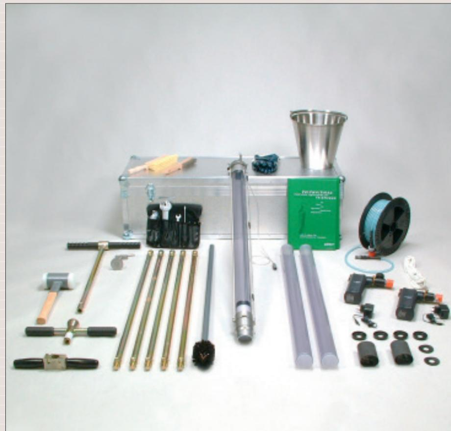
Sedimentstechprobennehmer Typ Beeker, vollständiges Basisset (04.23.SA)
